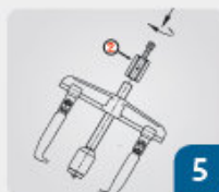
Recolocando a porca (2), enroscando-a até seu final
