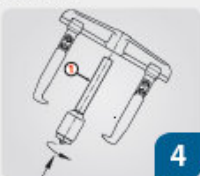
Introdução do fuso hidráulico no suporte, de baixo para cima
