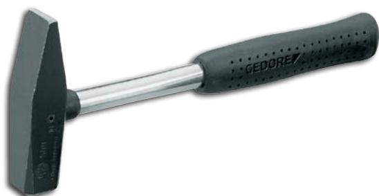
Cabeça forjada em aço especial Gedore, com acabamento escurecido e tratamento térmico total, batentes lixados e temperados por indução. Cabo em tubo de aço especial, com empunhadura ergonômica em polímero. Possui pino elástico para fixação da cabeça no cabo, e proteção no cabo, contra batidas em falso.
