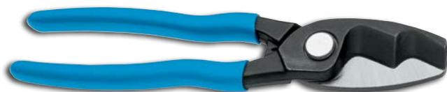
Utilizado para cortar cabo flexível de cobre e/ou alumínio de até Ø20 mm. Quando utilizado para pré-corte e corte final pode ser usado em cabos de até Ø25 mm. Navalhas tratadas termicamente possibilitando corte exato e sem rebarba. Não recomendado para uso em cabo de aço e perfis de cobre duro. Sistema de corte tipo guilhotina.
