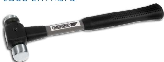
Cabeça forjada em aço Gedore-Vanadium, com acabamento escurecido e tratamento térmico total, batentes lixados e temperados por indução. Cabo em fibra de vidro pultrudada, com empunhadura ergonômica em polímero. Cunha em aço especial. Possui pino elástico para fixação da cabeça no cabo, e proteção no cabo, contra batidas em falso.
