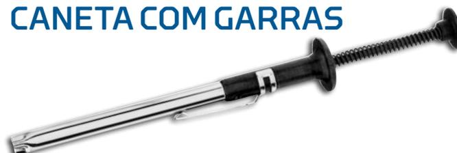
Conjunto compacto, tipo caneta. Utilizada em montagens e indicada para agarrar pequenas peças, posicionar parafusos e porcas pequenas em fendas e furos até 7,5 mm.
