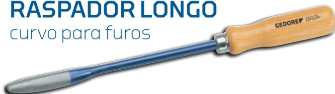
Raspador longo tipo colher. Formato americano. Haste em aço especial pintada e ponta lixada. Empunhadura em madeira reforçada com anel metálico.
