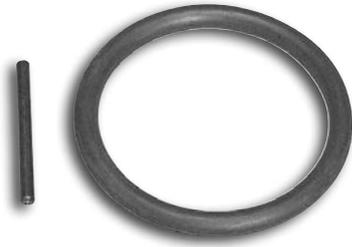
**Pino:** aço especial. Acabamento escurecido. **Anel:** elastômero. Para utilizar junto à linha de soquetes e acessórios de impacto com encaixe quadrado ■ 12,7 mm (1/2").
