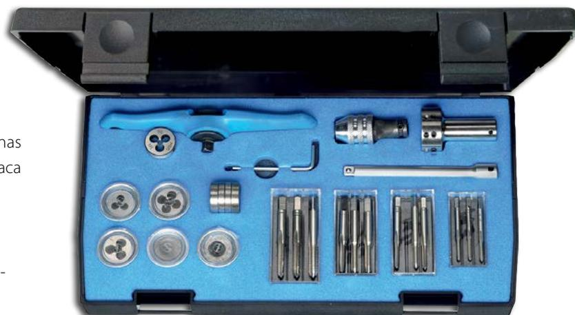
Para fazer roscas internas M3 a M6. Para fazer roscas externas M3 a M6 – máximo 40 mm de comprimento. Sistema de catraca com prolongador. Fornecido em estojo plástico.
