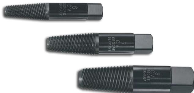
Aço Gedore-Vanadium. Utilização: executar um furo no centro do parafuso danificado (ver tabela), introduzir o extrator no furo e então extrair o parafuso danificado. Usar lubrificante se necessário. Aconselha-se utilizar sempre a maior medida possível de extrator.
