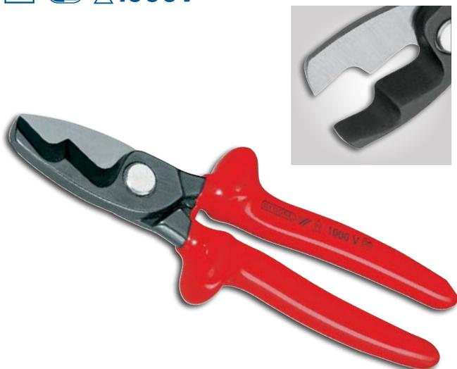
Cabos com isolamento VDE. Utilizado para cortar cabo flexível de cobre e/ou alumínio de até Ø20 mm. Quando utilizado para pré-corte e corte final pode ser usado em cabos de até Ø25 mm. Navalhas tratadas termicamente possibilitando corte exato e sem rebarba. Não recomendado para uso em cabo de aço e perfis de cobre duro. Sistema de corte tipo guilhotina.
