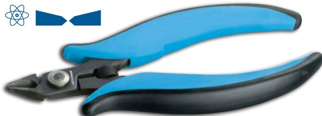
Com inserto para aumentar a robustez. Cabeça larga e pontuda. Corte inclinado (21°), com pequeno chanfro. Para corte de fio de cobre com diâmetro de até 2,0 mm / AWG 12 e fio de média dureza com diâmetro de até 1,6 mm / AWG 14.
