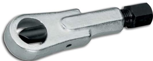
Corpo em aço Gedore-Vanadium, acabamento zincado, Fuso e navalha em aço especial com acabamento escurecido. Utilizado para extrair porcas encravadas ou danificadas sem prejudicar o fuso roscado. Indicado para porcas com resistência até a classe 6.
