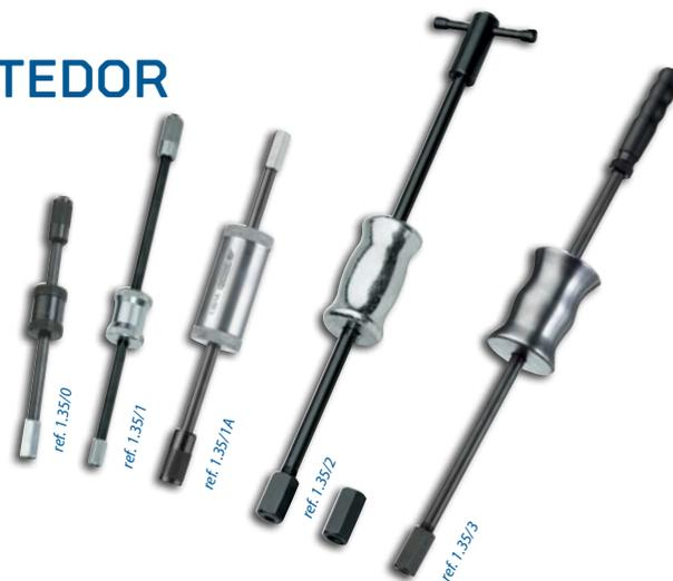
Indicado para extração de pequenos rolamentos, onde por falta de espaço para os apoios não se chega com o extrator normal. Utilizado em conjunto com garras ref. 1.30/0 a 1.30/9 ou ref. 1.34/1 a 1.34/4.
