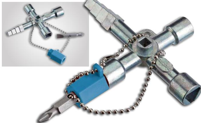
Chave em zinco fundido e polipropileno, bits e corrente em aço especial. Corrente com acabamento niquelado e cromado, bits com acabamento escurecido. Indicada para abertura e fechamento de ar condicionados, sistemas de ventilação e painéis de acesso diversos. Na área externa, indicado para tampas de luminárias públicas e travamento de containers de sucata/lixo.
