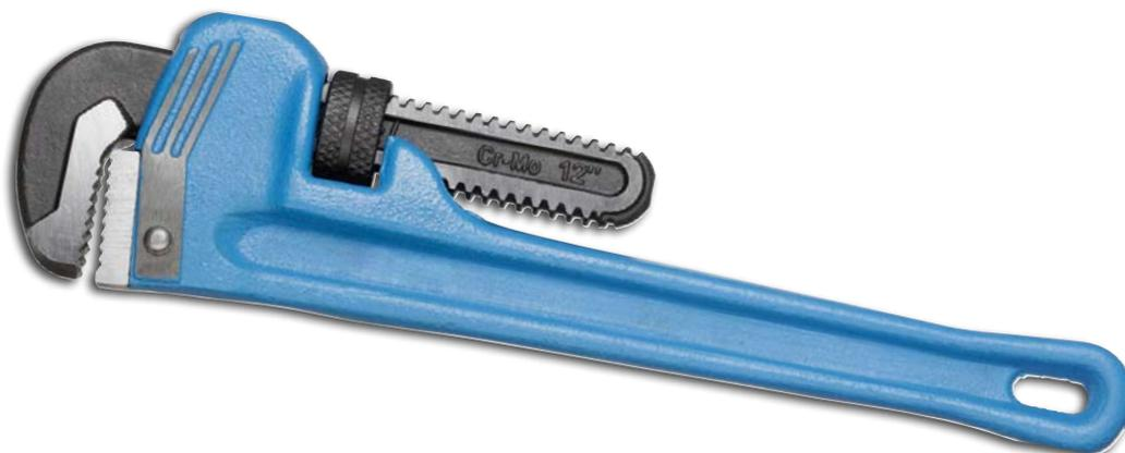
Cabeça e castanha em aço-liga de alta resistência mecânica. Cabo em ferro fundido nodular. Cabo com pintura eletrostática na cor azul. Modelo especial para trabalhos pesados e mordentes com tratamento térmico especial.
