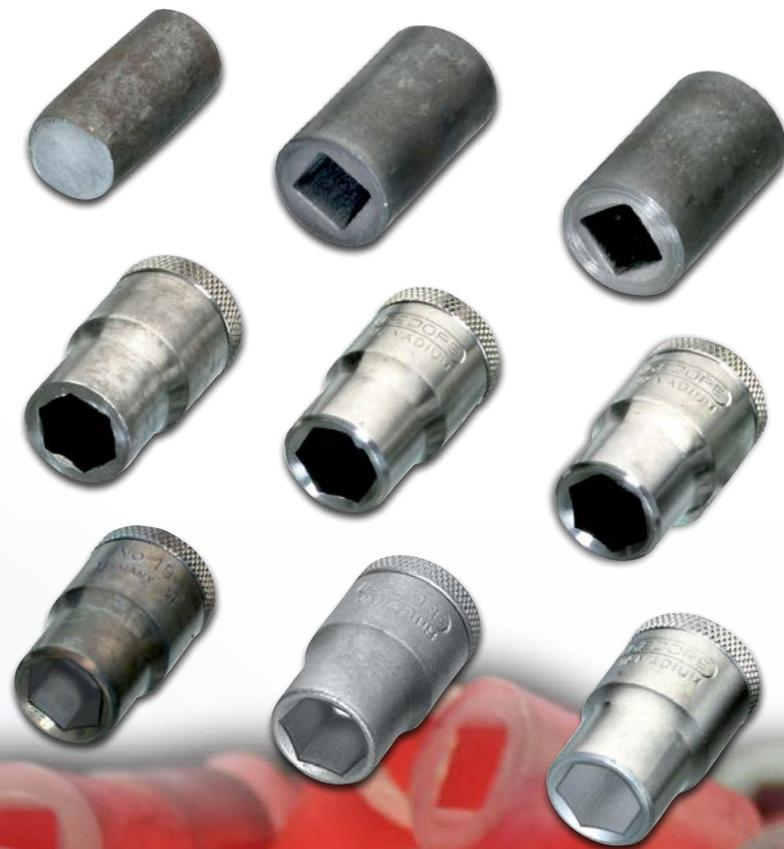
Se as fibras ficarem dobradas, o galho perde a estabilidade nesse ponto e parte-se. Como na natureza, a ponta do soquete Gedore, praticamente isenta de tensões, absorve melhor os picos de força que surgem repentinamente, em comparação aos modelos forjados a frio.
