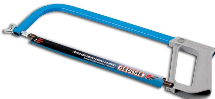
Cabo em alumínio com pintura eletrostática, arco em aço especial. Produto leve, de alta resistência e empunhadura ergonômica. Arco exclusivo para lâminas de 12". Armazena até 3 lâminas reservas no tubo do arco. Cabo fechado para maior proteção do usuário. Pode ser usado com lâmina na vertical ou com ângulo de 40° em relação ao arco.
