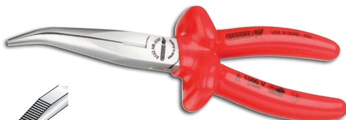
Polido e cromado. Alicate de bico longo e curvo (45°) com ponta oval. Tratamento térmico especial e corte temperado por indução. Indicado para cortar arame duro.
