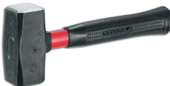
Cabeça forjada em aço Gedore-Vanadium, com acabamento escurecido e tratamento térmico total, batentes lixados e temperados por indução. Cabo em fibra de vidro de alta resistência, com empunhadura ergonômica em polímero. Cunha em aço especial. Possui pino elástico para fixação da cabeça no cabo, e proteção no cabo, contra batidas em falso.
