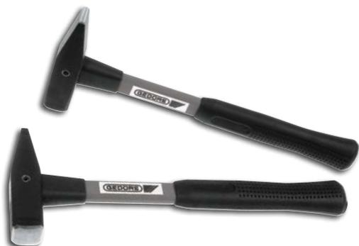
Cabeça forjada em aço Gedore-Vanadium, com acabamento escurecido e tratamento térmico total, batentes lixados e temperados por indução. Cabo em fibra de vidro pultrudada, com empunhadura ergonômica em polímero. Cunha em aço especial. Possui pino elástico para fixação da cabeça no cabo, e proteção no cabo, contra batidas em falso.
