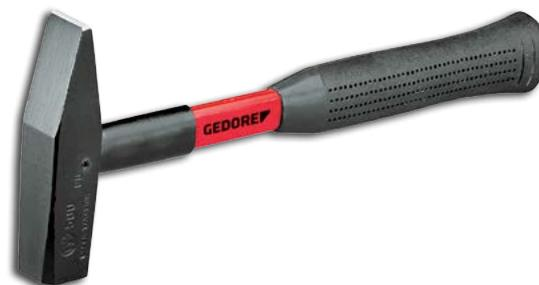
Cabeça forjada em aço Gedore-Vanadium, com acabamento escurecido e tratamento térmico total, batentes lixados e temperados por indução. Cabo em fibra de vidro de alta resistência, com empunhadura ergonômica em polímero. Cunha em aço especial. Possui pino elástico para fixação da cabeça no cabo, e proteção no cabo, contra batidas em falso.
