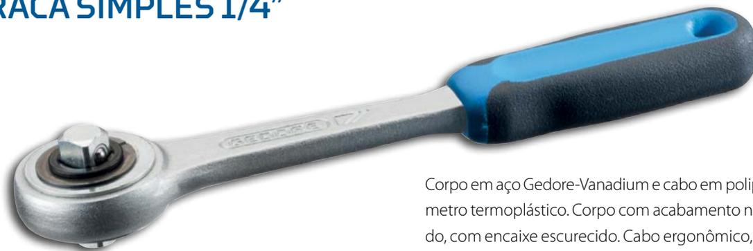
Corpo em aço Gedore-Vanadium e cabo em polipropileno e elastômetro termoplástico. Corpo com acabamento níquelado e cromado, com encaixe escurecido. Cabo ergonômico, em dois materiais antideslizante. Para soquetes e acessórios manuais com encaixe quadrado 6,35 mm (1/4"), conforme DIN 3120 - C 6.3, ISO 1174.
