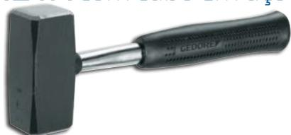
Cabeça forjada em aço especial Gedore, com acabamento escurecido e tratamento térmico total, batentes lixados e temperados por indução. Cabo em tubo de aço especial, com empunhadura ergonômica em polímero. Possui fixação com pino de segurança.
