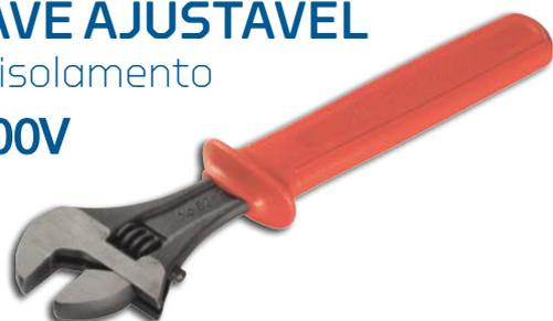
Forjada em aço Gedore-Vanadium. Acabamento escurecido. Endurecida e temperada, oferece alta resistência mecânica, assegurando excelente performance por muito mais tempo. Cabeça lixada. Modelo sueco: inclinação de 15° da cabeça em relação ao cabo garante estabilidade no manuseio.
