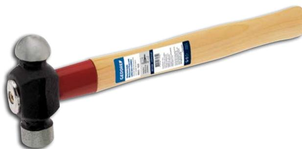
Cabeça forjada em aço Gedore-Vanadium, com acabamento escurecido e tratamento térmico total, batentes lixados e temperados por indução. Cabo ergonômico em madeira nobre. Sistema de segurança na fixação do martelo em aço especial – cunha, tampa do cabo e proteção Rotband-Plus, contra batidas em falso.
