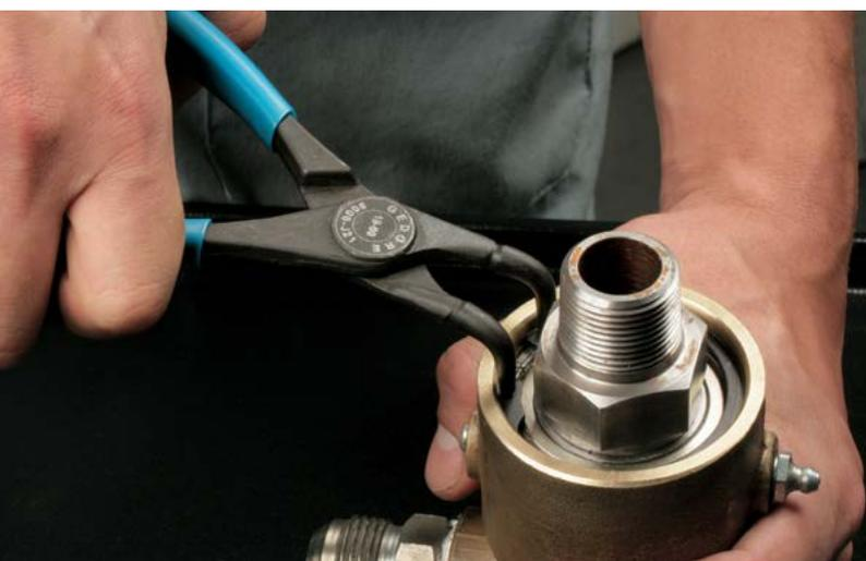
**Os alicates para anéis têm como finalidade a montagem e desmontagem de anéis de segurança internos ou externos que tenham furos para o encaixe dos alicates, conforme norma DIN 471 e DIN 983.**
