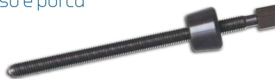
Composto apenas por fuso e porca, o sacarrolamento deve ser utilizado em conjunto com o jogo de garras ref. 1.29 (ver tabela). Indicado para extrair rolamentos de esfera que se encontram simultaneamente fixados nos anéis externo e interno. As garras usadas são introduzidas no anel externo de acordo com a quantidade de esferas distribuídas de forma uniforme no retentor. Para uso na posição vertical.
