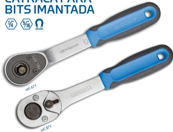
Corpo em aço Gedore-Vanadium e encaixe em aço especial, empunhadura em polipropileno e elastômero termoplástico, imã de neodímio. Corpo com acabamento niquelado e cromado fosco, encaixe escurecido. Cabo ergonômico, em dois materiais antideslizante. Com alavanca de comutação de sentido de giro, indicada para trabalhar em áreas restritas. Encaixe hexagonal interno conforme norma DIN 3126 - D.
