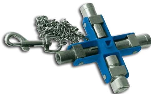
Chave em zinco fundido e polipropileno, bits e corrente em aço especial. Corrente com acabamento niquelado e cromado, bits escurecido. Indicado para todas as fechaduras comuns, possui nove aplicações. Oito fechaduras de diferentes quadros de distribuição e quadrado de 5 mm para ventiladores. Economia de espaço graças ao formato plano e mecanismo de rotação.
