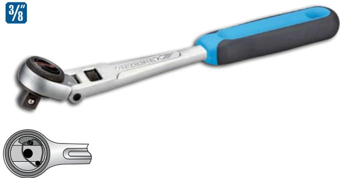
Corpo em aço Gedore-Vanadium e cabo em polipropileno e elastômetro termoplástico. Corpo com acabamento niquelado e cromado, com encaixe escurecido. Cabo ergonômico, em dois materiais antideslizante. Possui disco de reversão do sentido de giro. Para soquetes e acessórios manuais com encaixe quadrado ■ 9,52 mm (3/8"), conforme DIN 3120 - C 10, ISO 1174. Articula até 180°, com trava na articulação. Torque máximo 200 N.m.
