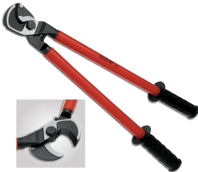
Cabeça em aço especial, com acabamento escurecido. Cabos em tubo de alumínio com revestimento esmaltado a pó, empunhadura ergonômica em borracha. Indicada para corte de cabo de cobre e alumínio com diâmetro máximo de Ø 27 mm, e seção máxima de 150 mm<sup>2</sup>. Não recomendada para corte de cabos e fios de aço. Nova geometria de corte permite um corte limpo e suave, com o menor esforço do usuário.
