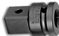
Aço-liga de alta resistência mecânica. Acabamento escurecido. Para acessórios de impacto com encaixe quadrado 9,52 mm (3/8"), conforme DIN 3121, ISO 1174. Possui alojamento para pino e anel de segurança.
