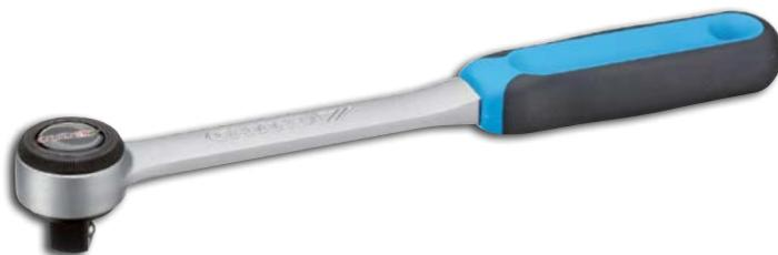
Corpo em aço Gedore-Vanadium e cabo em polipropileno e elastômero termoplástico. Corpo com acabamento niquelado e cromado, com encaixe escurecido. Cabo ergonômico, em dois materiais antideslizante. Possui disco de reversão do sentido de giro. Para soquetes e acessórios manuais com encaixe quadrado ■ 12,7 mm (1/2"), conforme DIN 3120 - C 12.5, ISO 1174.
