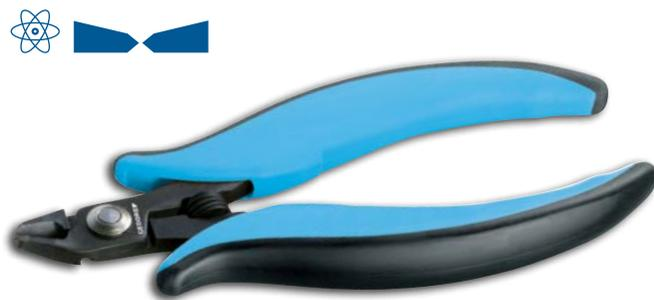
Coberto com Tungstênio para situações críticas. Corte inclinado (21°), com pequeno chanfro. Para corte de fio de cobre com diâmetro de até 2,0 mm / AWG 12, fio de média dureza com diâmetro de até 1,6 mm / AWG 14 e fio plano com diâmetro até 0,6 mm / AWG 22.
