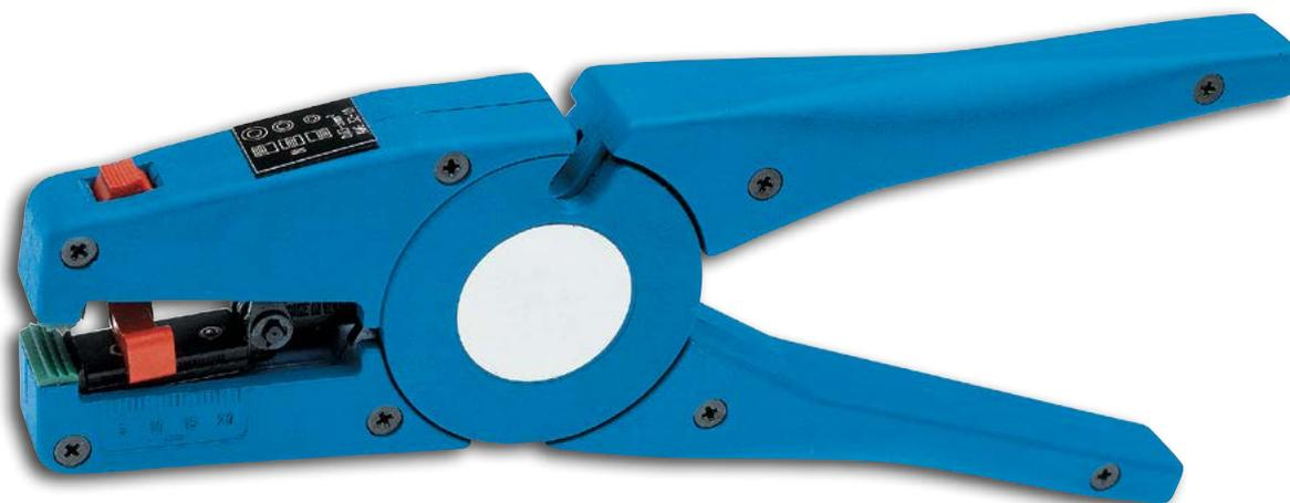
Alicate seguro e sem fadiga através de moldagem ergonômica. Sua estrutura é reforçada por fibra de vidro poliamido. Duração de uso é de aproximadamente 50.000 operações. Leve e de marcha suave, permite ajuste automático para cada corte transversal. Possibilita ajuste para diferentes espessuras de isolamento (comprimento para desencapar ajustável de 1 a 16 mm).
