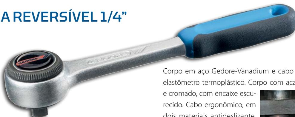
Corpo em aço Gedore-Vanadium e cabo em polipropileno e elastômetro termoplástico. Corpo com acabamento níquelado e cromado, com encaixe escurecido. Cabo ergonômico, em dois materiais antideslizante. Possui disco de reversão, com dentes finos (72 dentes). Para soquetes e acessórios manuais com encaixe quadrado 6,35 mm (1/4"), conforme DIN 3120 - C 6.3, ISO 1174.
