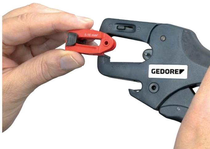
Alicate desencapador de ajuste automático
