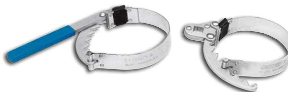
Niquelado. Cinta de metal ajustável para todos os filtros de óleo e peças cilíndricas. O saca-filtro ref. 37 possui cabo próprio. O saca filtro ref. 37 V possui encaixe interno 12,7 mm (1/2") para uso com torquímetros ou acessórios.
