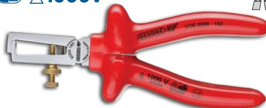
Polido e cromado. Com mola e regulagem de abertura pelo parafuso de ajuste. Indicado para arames de 0,8 a 6,0 mm<sup>2</sup>.
