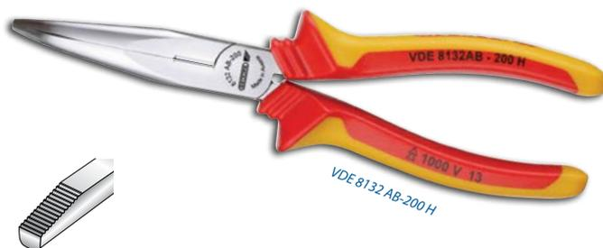
Polido e cromado. Alicate de bico longo e curvo (45°) com ponta oval. Tratamento térmico especial e corte temperado por indução. Indicado para cortar arame duro.
