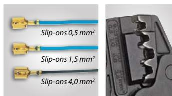
Para terminais não isolados, com bucha aberta, tais como slip-ons. Conductor e isolamento são trabalhados em operação única.
