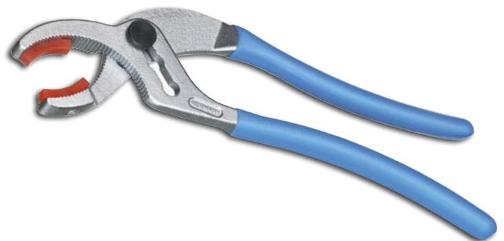
Aço especial Gedore, acabamento cromado e empunhadura plastificada. Possui articulação com três níveis de regulagem. Indicado especialmente para conectores Canon ou outros conectores roscados. Mordentes com revestimento de plástico com 11 mm de largura protegem superfícies sensíveis (aparafusados e substituíveis - ref. E 8386).
