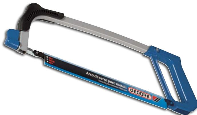
Corpo em alumínio com pintura eletrostática e proteção em polímero. Arco em aço especial. Produto leve, de alta resistência e empunhadura ergonômica. Arco exclusivo para lâminas de 12". Cabo fechado para maior proteção do usuário. Pode ser usado com lâmina na vertical ou com ângulo de 90° em relação ao arco. Possui um tensor para aperto e desaperto da lâmina.
