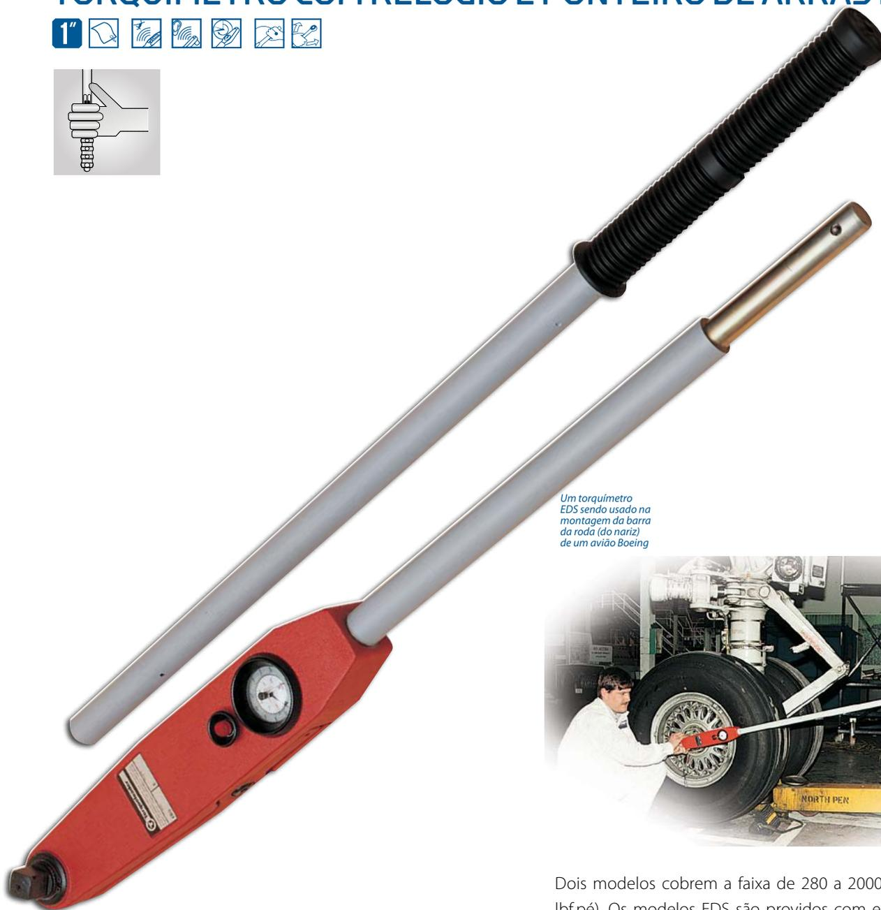
Um torquímetro EDS sendo usado na montagem da barra da roda (do nariz) de um avião Boeing
