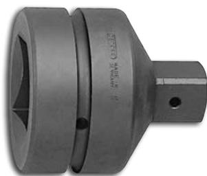
Aço-liga de alta resistência mecânica. Acabamento escurecido. Para acessórios de impacto com encaixe quadrado  $\blacksquare$  63,5 mm (2.1/2"), conforme DIN 3121, ISO 1174. Possui alojamento para pino e anel de segurança.
