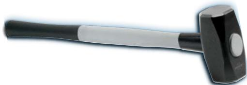
Cabeça forjada em aço especial Gedore, com acabamento escurecido, batentes lixados e temperados por indução. Cabo em fibra de vidro com reforço pultrudado no centro, garante alta resistência mecânica, térmica e à corrosão, e possui baixo peso em comparação ao metal. Empunhadura ergonômica em polímero. Proteção no cabo, contra batidas em falso. Ferramenta desenvolvida para atividades extrapesadas.
