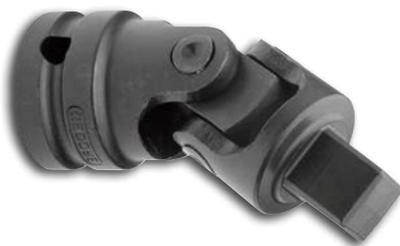
Aço-liga de alta resistência mecânica. Acabamento escurecido. Para soquetes de impacto com encaixe quadrado 25,4 mm (1"), conforme DIN 3121, ISO 1174. Possui alojamento para pino e anel de segurança.
