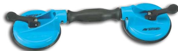
Material ABS. Utilizada no manuseio de vidros curvos de até 45 kg. Com duas ventosas oscilantes, sistema de aspiração e trava de segurança. Os discos de aspiração são intercambiáveis, com diâmetro de Ø 120 mm. Indicada para manuseio de pára-brisas.
