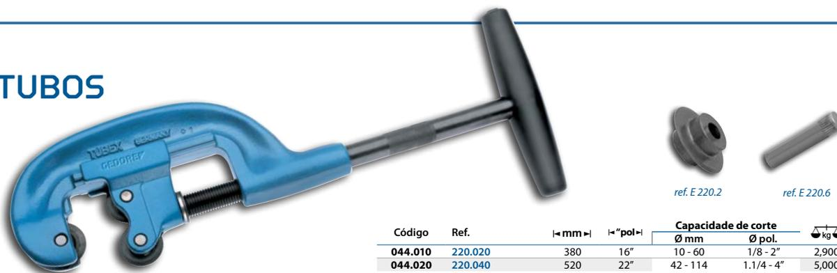
Ferramenta robusta e de grande precisão para cortes de tubos em aço com paredes de até 6,5 mm, inclusive aço inoxidável. Navalha de corte e roletes em aço de alta resistência mecânica. Fuso longo com empunhadura, facilitando o aperto e o corte. O corta tubo ref. 220.040 possui alavanca auxiliar.
