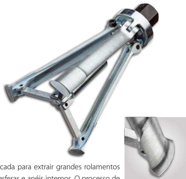
Indicada para extrair grandes rolamentos de esferas e anéis internos. O processo de funcionamento inicia girando a porca, desta forma os mordentes da garra se abrem. Com este novo sistema de expansão, consegue-se um ajuste simples e progressivo no diâmetro desejado. Os perfis das arestas vivas dos mordentes de extração adaptam-se niveladamente sob o rolamento durante a expansão. Utilizado em conjunto com o suporte para extração interna ref. 1.36/4.
