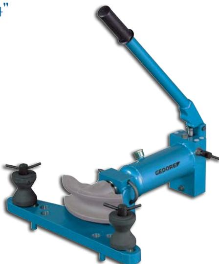
Para tubos de gás e água EN 10255 (DIN 2440/2441) até 90°. Operação manual-hidráulica. Com armação de curvar aberta ou rebatível. Aparelho básico, fornecido sem segmentos de curvar. Força de pressão máxima 60 kN.
