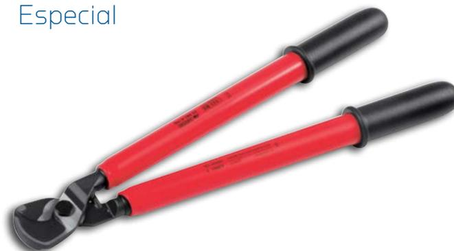
Possui um sistema de corte fácil. Corta cabos de cobre e alumínio de até Ø 35 mm e material maciço com seção de até 180 mm<sup>2</sup>
