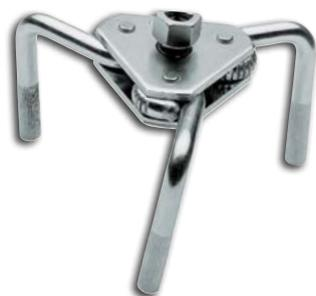
Com acionamento quadrado interno de 3/8" e adaptador 1/2", com sextavado externo de 17 mm. Faixa de trabalho: 60 a 120 mm.
