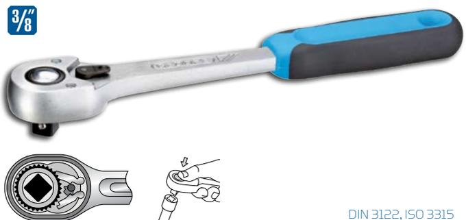
Corpo em aço Gedore-Vanadium e cabo em polipropileno e elastômetro termoplástico. Corpo com acabamento niquelado e cromado, com encaixe escurecido. Cabo ergonômico, em dois materiais antideslizante. Alavanca de reversão, com trava na posição central, e botão para desengate. Para soquetes e acessórios manuais com encaixe ■ 9,52 mm (3/8"), conforme DIN 3120 - C 10, ISO 1174.
