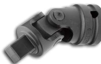
Aço-liga de alta resistência mecânica. Acabamento escurecido. Para soquetes de impacto com encaixe quadrado 9,52 mm (3/8"), conforme DIN 3121, ISO 1174. Possui alojamento para pino e anel de segurança.
