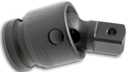
Aço-liga de alta resistência mecânica. Acabamento escurecido. Articula até 30°. Para soquetes de impacto com encaixe quadrado ■ 12,7 mm (1/2"), conforme DIN 3121, ISO 1174. Possui alojamento para pino e anel de segurança.
