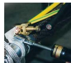
Os modelos TLS Standard FH / TLS Standard FH são fornecidos com hexagonal fêmea de 1/4”, para bits com encaixe sextavado de 6,35 mm (1/4”). Com quatro opções de cor para rápida identificação de torque pré-ajustados, de acordo com a sua necessidade: azul, verde, vermelho ou dourado.
