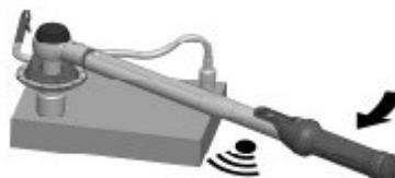
A seguir, ajuste a ferramenta dinamométrica para o respectivo binário máximo permitido. Regule o disco graduado para o ângulo desejado.
