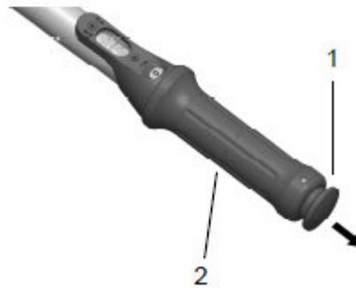
Rodar o punho (2), até que o binário desejado da respectiva escala (3) N-m ou lbf-ft / lbf-in coincida com a marcação na lupa.
