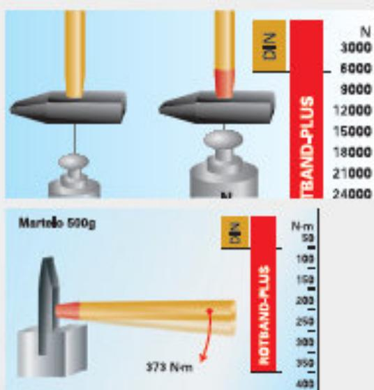
Os martelos Gedore ROTBAND-PLUS superaram consideravelmente os valores requeridos pela norma DIN. De acordo com relatório do VPA – Instituto de Análise e Testes em Ferramentas de Remscheid (Alemanha) – os martelos ROTBAND-PLUS atingiram uma força aplicada cinco vezes superior em comparação aos demais martelos
