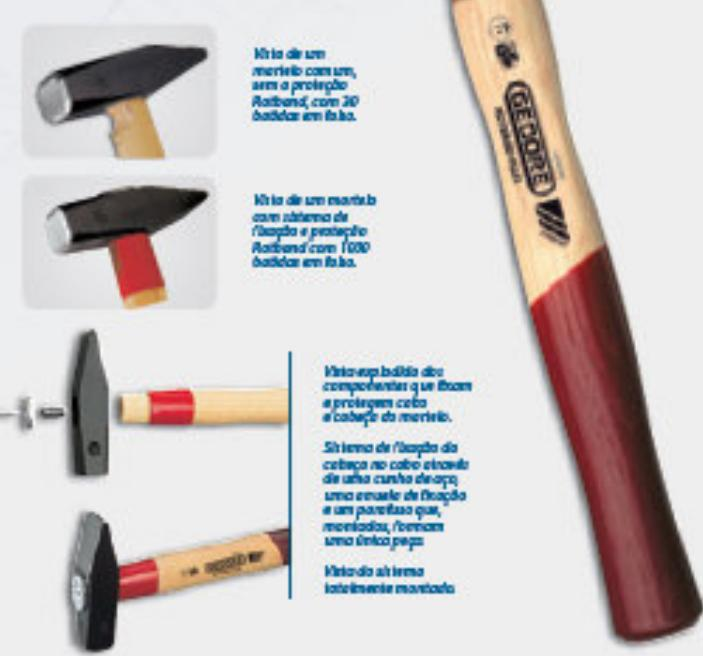
Com a proteção metálica e o sistema de fixação da cabeça com cunha, arruela e parafuso no martelo ROTBAND-PLUS, a resistência do cabo é superior à dos demais martelos padrão DIN. Tudo isto aumenta a segurança do usuário e a durabilidade da ferramenta.
