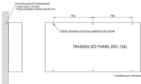
ORIENTAÇÃO PARA MONTAGEM DO PAINEL R1501 EM BANCADAS GEDORE COM TAMPOS DE 2 METROS
